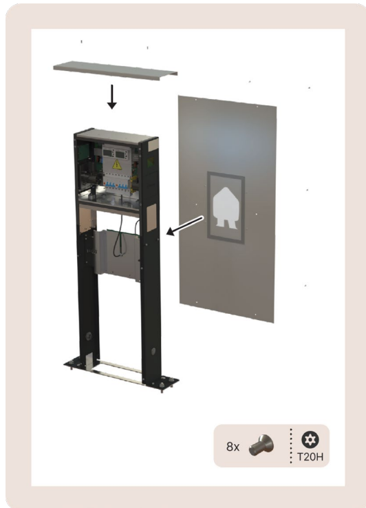
Afbeelding 22: de topplaat (A) en de voorplaat (B)
