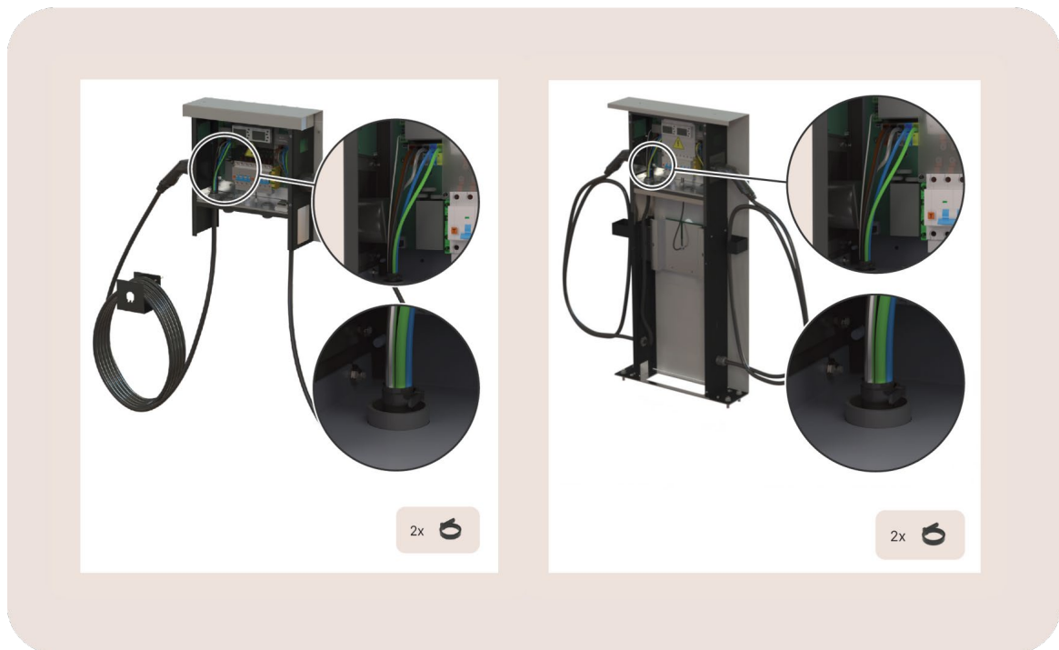
Afbeelding 32: de kabelaan sluitingen voor een aan de muur gemonteerde en op de vloer gemonteerde EV Dual
