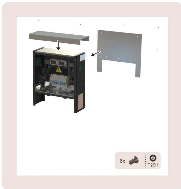
Afbeelding 24: de topplaat (A) en de achterplaat (B)
