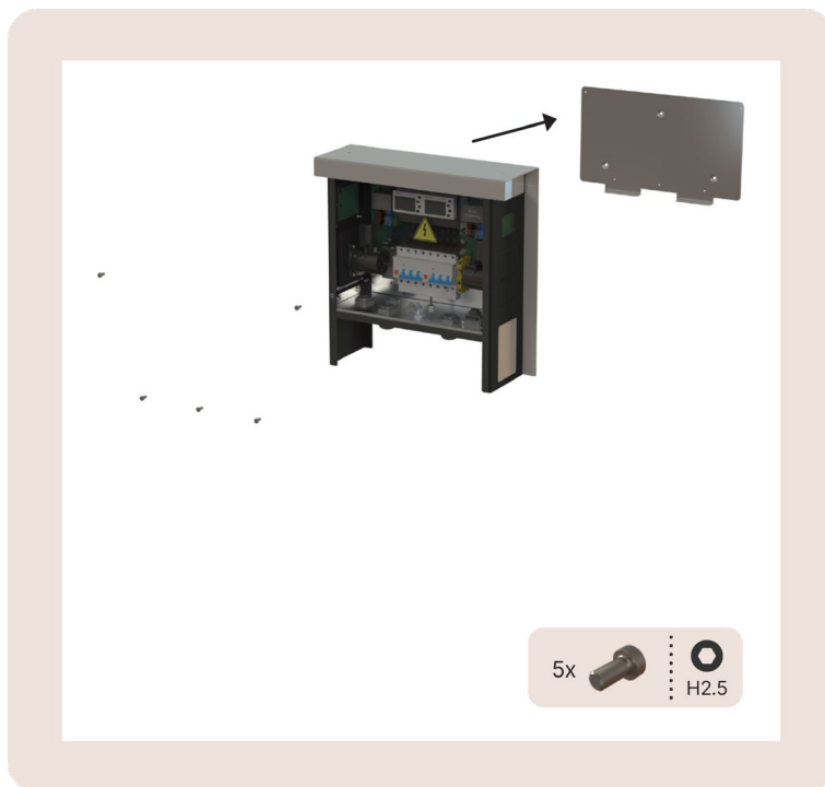
Afbeelding 25: de wandmontageplaat (A) en de EV Dual Core (B)
