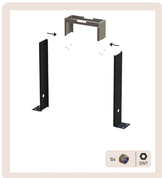
Afbeelding 13: de dwarsbalk (A) en zijbeugels (B)
